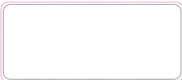
Druckbarer Bereich 75x32mm, Eckradius 3mm
